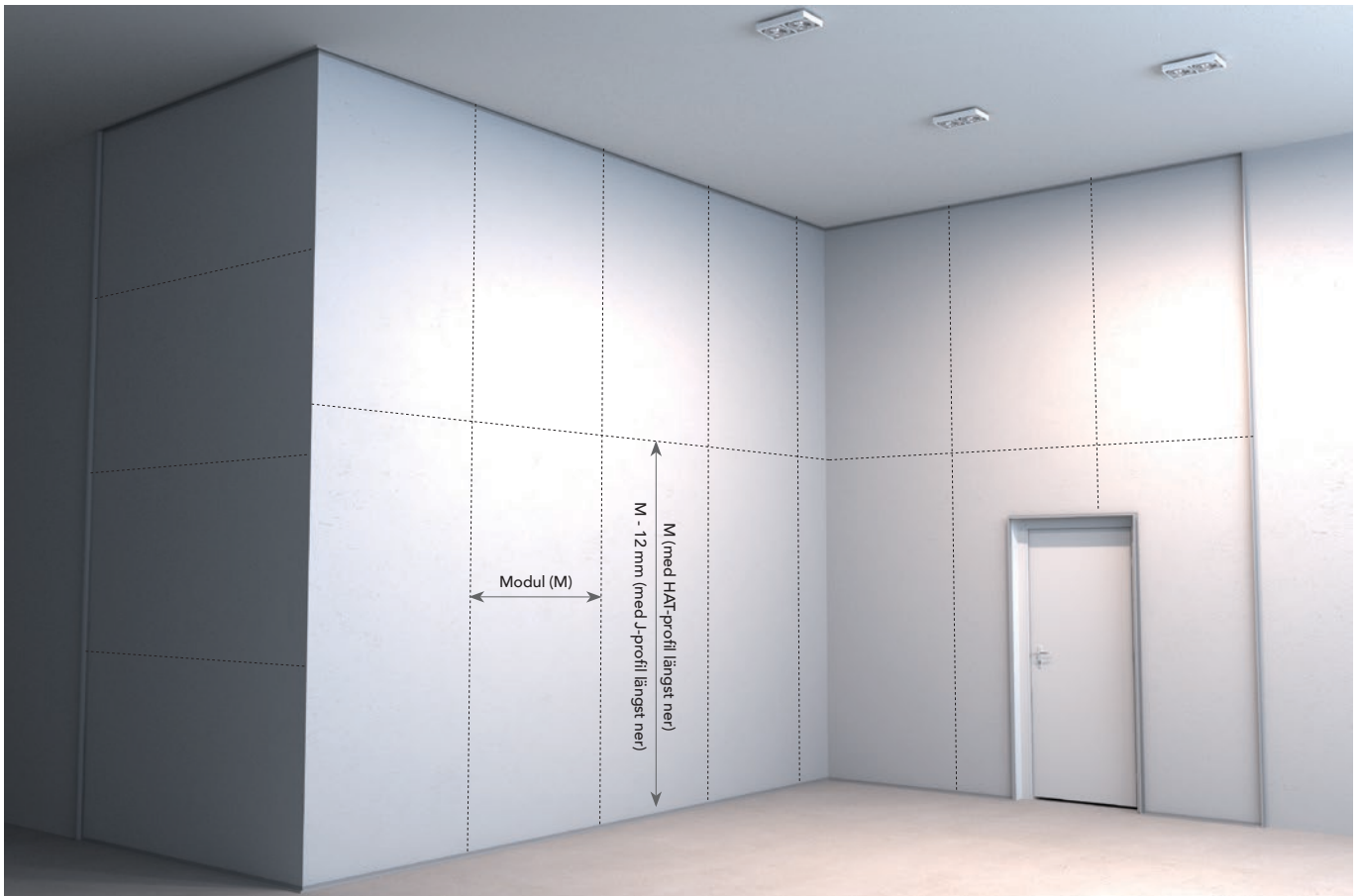
1.1 Markera placeringen av ramen (J-profiler) och HAT-profilerna enligt modulstorlek.
