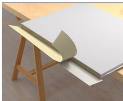
5. Ta bort resten av folien. Viktigt: Vid tillpassning av Rockfon MediCare Block undertaksskivor rekommenderar vi alltid silikontätning.
