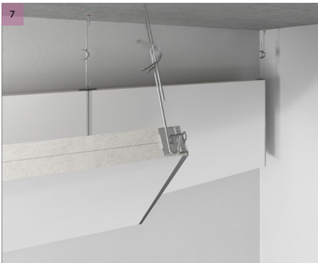
Om det behövs - vrid baffeln så blir det lättare att få i pendelns krok i baffelns ögla.
