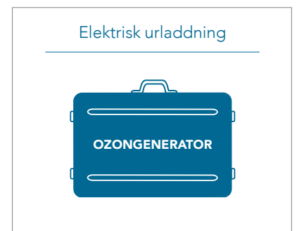
Det omvandlas till ozon genom av en elektrisk urladdning.
