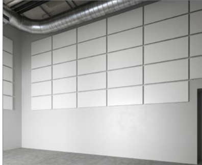
Ett minsta avstånd mellan skivorna på 36 mm behövs för att montera väggfästet.
