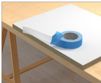
2. Zmierzyć krawędź, dodać 10mm, odciąć na wymiar i zdjąć 5mm pasek papieru.
