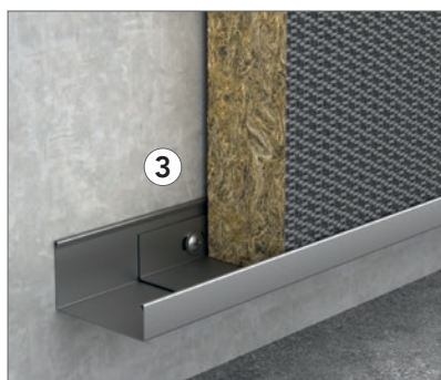
Do podparcia paneli wykorzystuje się profile obwodowe J 40 mm (25/40/13 mm) oraz wsporniki. W przypadku profili obwodowych J o grubości 1 mm nie ma konieczności stosowania wsporników.
