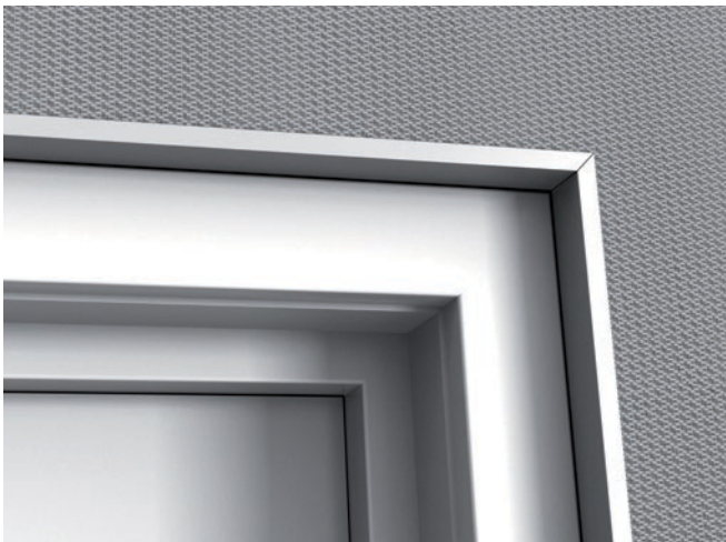
3.9 Rammene rundt dører eller vinduer skal alltid lages med J-profiler monteret med den brede kanten på 25 mm til veggen, festet for hver 300 mm. Platen måles til og tilskjæres nøyaktig, slik at det sikres at platen er stor nok slik at den overlappes av J-profil rammene.
