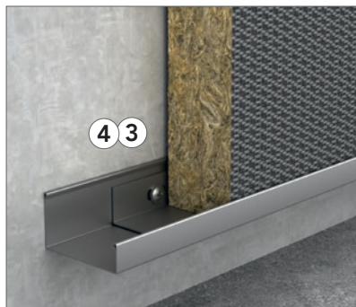
Den 40 mm J-profilen (25/40/13 mm) og ded tilhørende montasjevinkelen benyttes til å støtte bunnen av veggabsorbentene ved montasje i forskjellige høyder eller uten gulvstøtte. Ved bruk av 1 mm tykke J-profiler er montasjevinkler ikke nødvendige.
