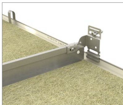
For å sikre at Rockfon System T24 X er montert korrekt og kvadratisk, anbefales det å benytte et vegg- og overgangsbeslag på hver bæreprøfil og annenhver tverrprofil.
