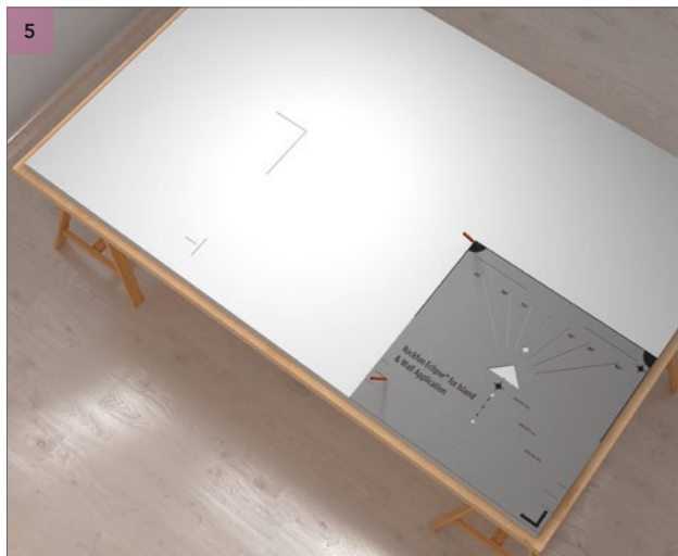
Plasser markeringsmalen i nederste høyre hjørne på baksiden av Rockfon Eclipse veggabsorbenten. Marker senterlinjene ved å tegne langs motsatte hjørne av markeringsmalen og marker plasseringen av avstandsholderen.
