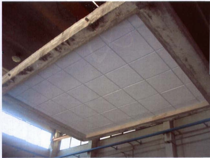
Fotografia della superficie d'intradosso del campione prima della prova.
