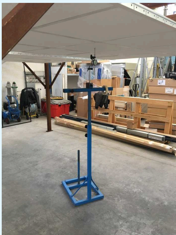
Fotografie del comparatore analogico durante la prova.
