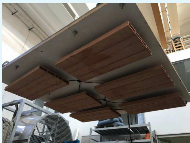
Fotografia del posizionamento di elementi tavella-piastra sotto il pannello in legno multistrato.
