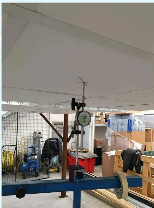
Fotografie del comparatore analogico durante la prova.
