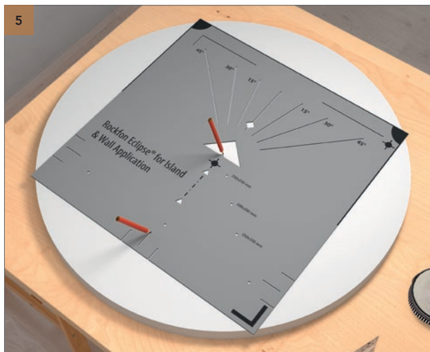
5 Posiziona la dima nella parte posteriore del pannello murale Rockfon Eclipse. Con una matita traccia i contorni della punta alla base del triangolo nella dima e la posizione del distanziatore. Vedi immagine 5 "Risultato".
