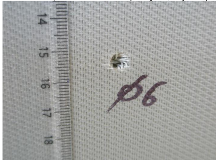
Constat de perforation \varnothing 10 mm (énergie 3,75 joules)
