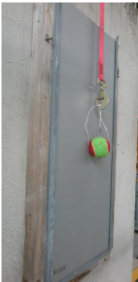
Photographies n° 1 à 3 : Dispositifs d'essais – chocs ball de tennis, balle et ballon
