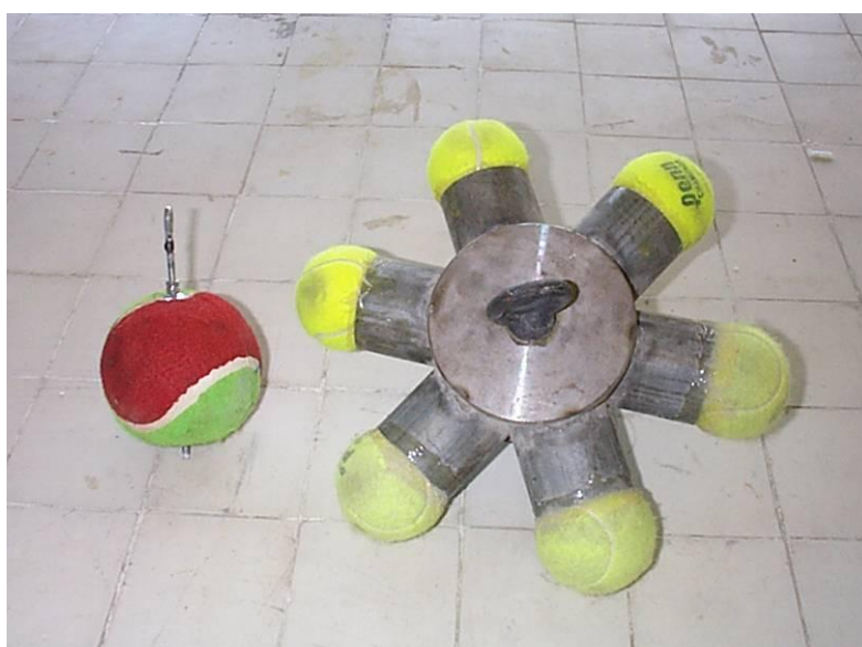
Photographie n° 4 : Dispositif d'essais – essais de chocs à la balle de tennis lestée et balle
