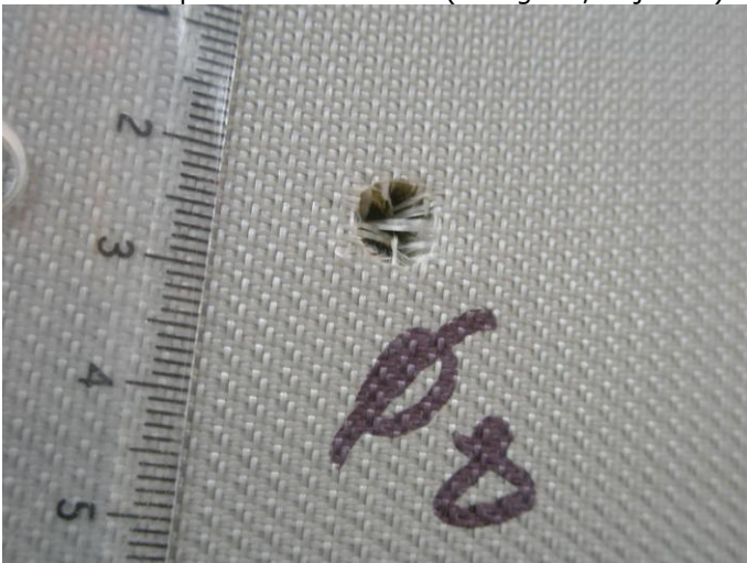
Constat de perforation partielle \varnothing 12 mm (énergie 3,75 joules)
