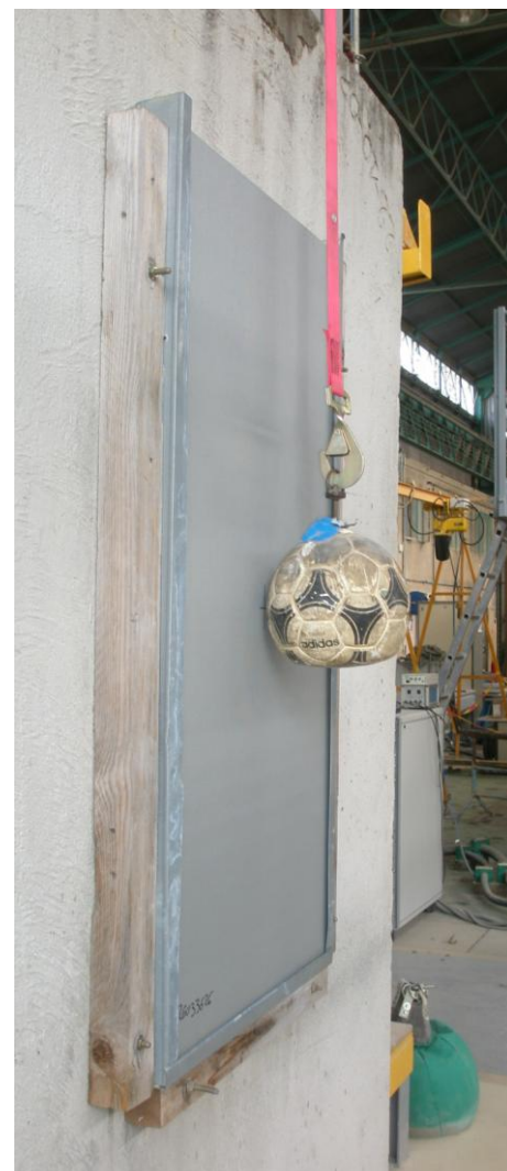
Photographies n° 1 à 3 : Dispositifs d'essais – chocs ball de tennis, balle et ballon
