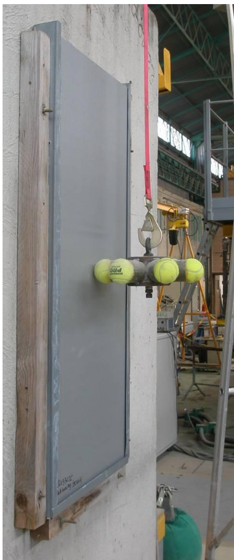
Photographies n° 1 à 3 : Dispositifs d'essais – chocs ball de tennis, balle et ballon
