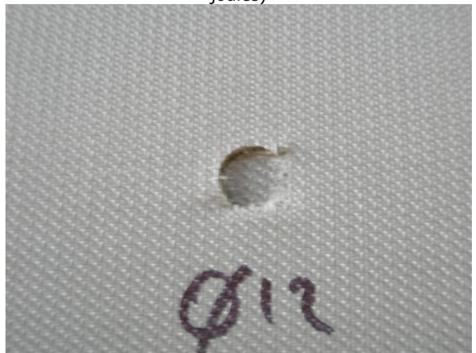
Constat de perforation partielle \varnothing 12 mm (énergie 3,75 joules)
