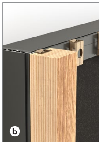
Appuyez sur la face avant de chaque latte pour qu'elles soient bien fixées aux profilés horizontaux sur les clips de montage.
