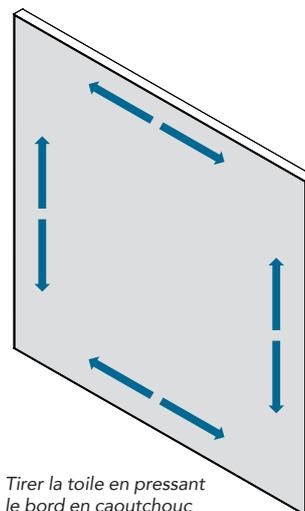
3. Tirer la toile en pressant le bord en caoutchouc vers les rainures du haut, du bas et des deux côtés. Travailler zone par zone pour une meilleure distribution du tissu dans l'ensemble du cadre et éviter tout pli ou froissement.
