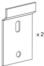
\* Si la largeur du panneau est supérieure à 2500 mm, 3 supports muraux sont nécessaires et inclus dans le carton.
