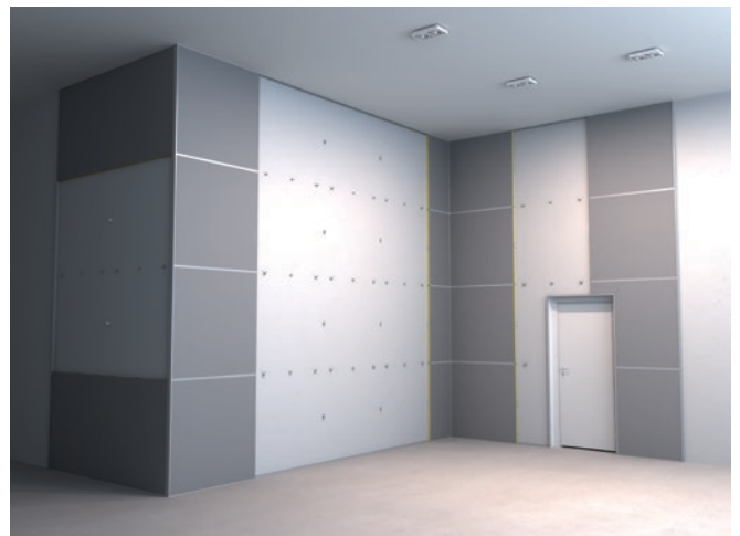
3.10 Recouvrir tous les joints horizontaux restants entre les panneaux en raccordant un profil T24 à des pattes de fixation. Les profils horizontaux doivent être coupés à la dimension exacte de M - 12 mm. Vérifier que les extrémités extérieures des raccords horizontaux soient recouvert par les finitions périphériques.
