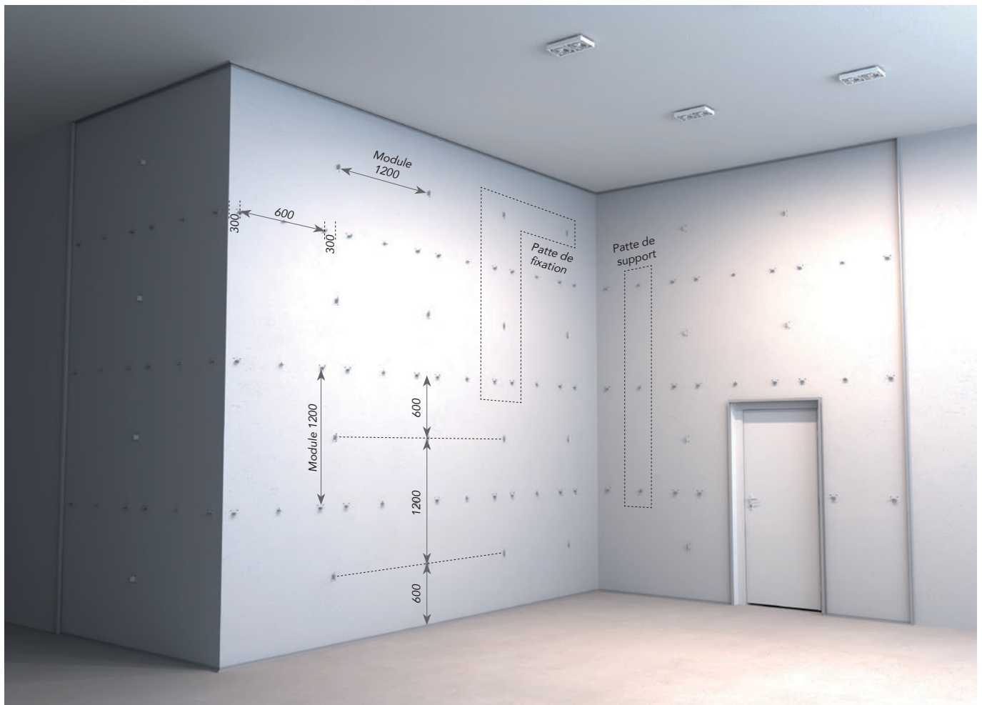
2.1 Les pattes de fixation et pattes de support doivent être positionnées et fixées avant que l'installation des panneaux commence. Cette méthode réduit la durée du montage. Assurez-vous que les pattes soient alignées ; les pattes de fixation du profil sur l'axe du module, les pattes de support 4 mm en-dessous à partir du dessus.
