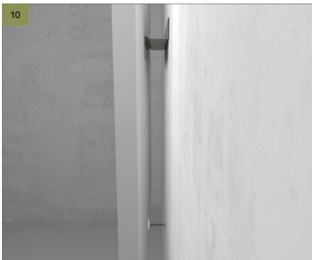
Positionner le panneau mural Rockfon Eclipse sur le profilé de fixation qui est au mur et ajuster l'écarteur jusqu'à ce que le panneau soit nivelé.
