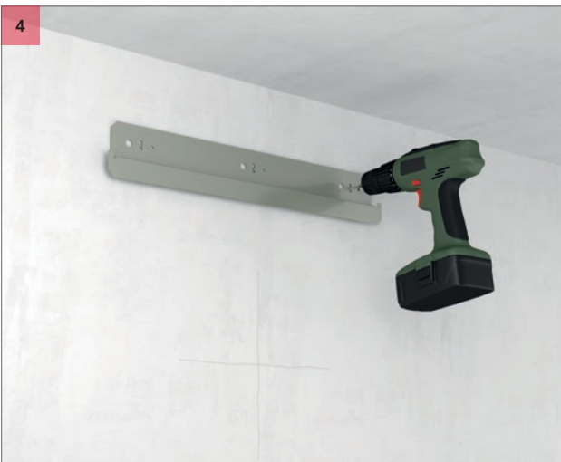
4 Percer les trous et installer le profilé de fixation murale.
