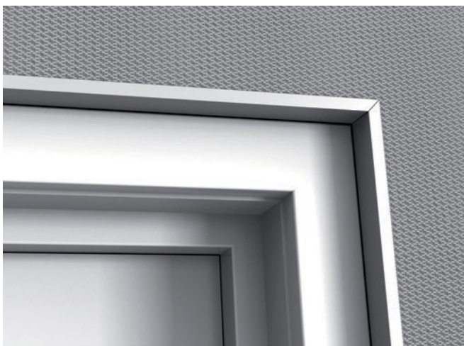
3.9 Ovia tai ikkunoita ympäröivissä kehyksissä on aina käytettävä J-listoja, jotka asennetaan seinään leveällä 25 mm:n laipalla 300 mm:n välein. Levyt mitataan ja sahataan huolellisesti, jotta varmistetaan, että levyt ovat riittävän kookkaita, jotta kehys voi limittyä.
