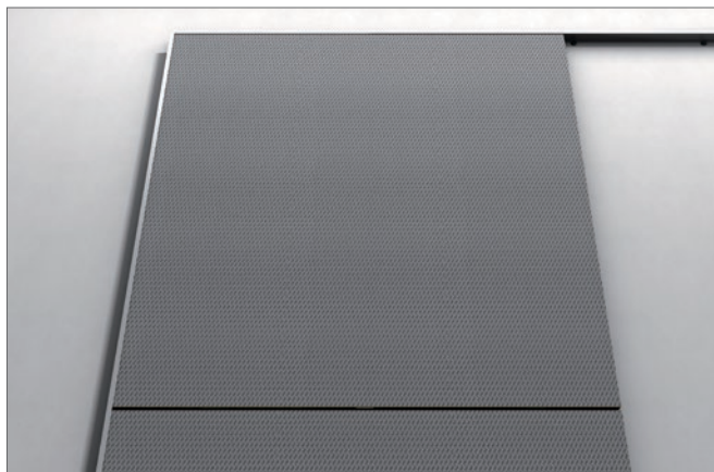
3.5 Asenna mahdolliset keskilevyt ylhäältä alas. Ne on kiinnitettävä kunnolla vähintään yhdellä kantavalla kiinnikkeellä ja J-listalla, ks. kaavio sivulla 6.
