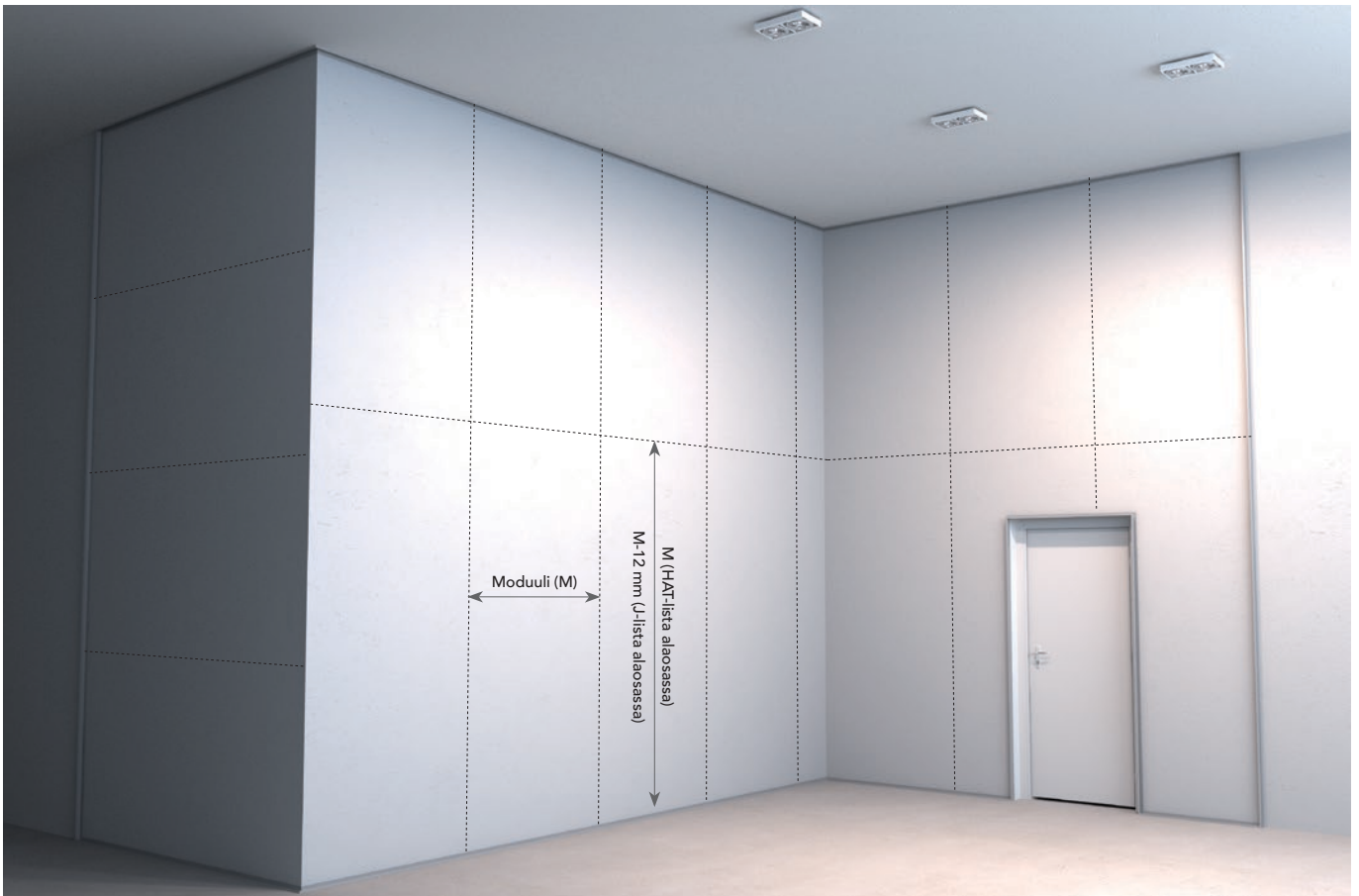
1.1 Kehyksen (J-listojen) ja HAT-listojen sijainnin tulee vastata moduulin mittoja.
