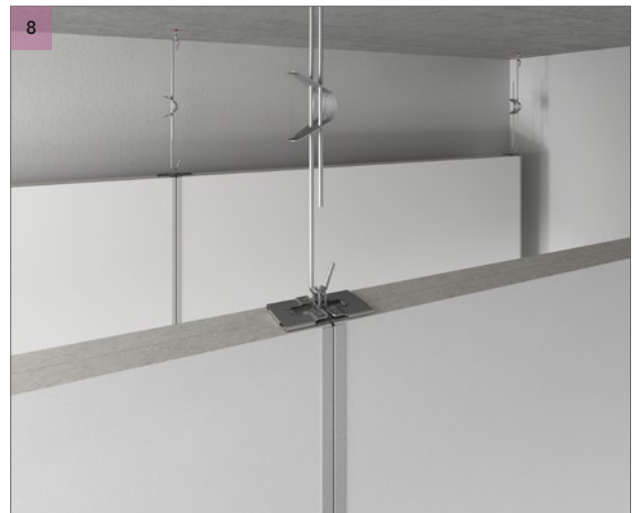
Jos ripustat samaan lankaripustimeen kaksi Rockfon Industrial -baffleria, varmista, että kohdistuskohoumat menevät oikein paikoilleen.
