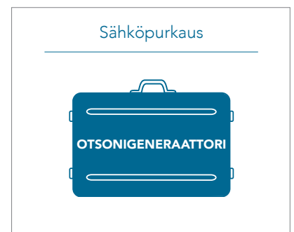
Se muutetaan otsoniksi sähköpurkauksen avulla.
