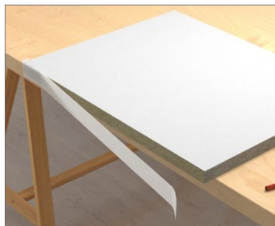
3. Alinear la superposición de 5 mm en la parte delantera y presionar.
