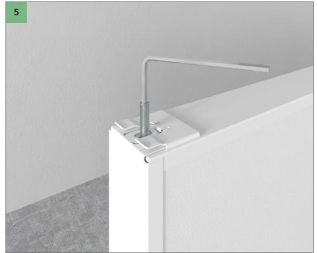
Al fijar deflectores directamente al Soporte de Fijación Directa ECR, use la varilla roscada M6 ECR de 30 mm de clase D y atorníllelo en la rosca M6 en el deflector (usando un destornillador plano o una llave hexagonal). Asegúrese de tener suficiente rosca encima del deflector - aprox. 20-25 mm - para la tuerca M6.
