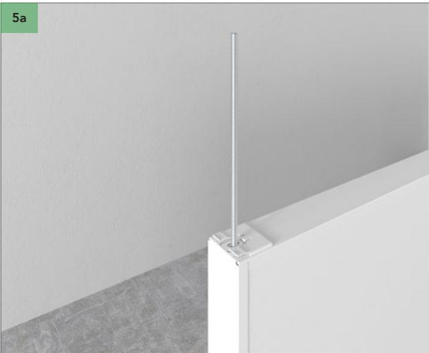
Al suspender los deflectores a 300 mm (o cualquier otra altura deseada <1000 mm) del techo, use la varilla roscada M6 ECR de 1000 mm de clase D, córtela en la longitud deseada y atornille el lado no cortado en la rosca M6 en el deflector. Asegúrese de tener suficiente rosca encima del deflector - aprox. 20-25 mm - para la tuerca M6 y use la tapa protectora M6.
