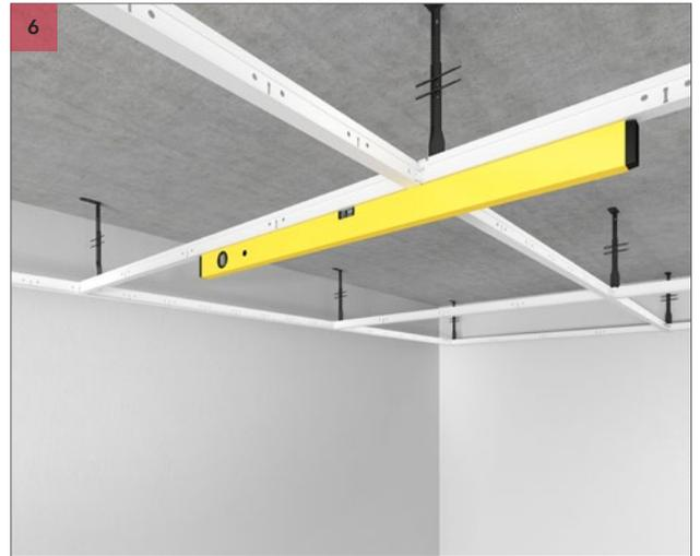
Instale perfiles secundarios T24 ECR en los perfiles primarios cada 1200 mm. Asegúrese de que la perfilera esté nivelada antes de instalar los baffles. Use los pasadores de bloqueo para ajustar el nivel correcto para todos los perfiles T24.
