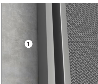
Los perfiles HAT se fijan directamente a la pared.
