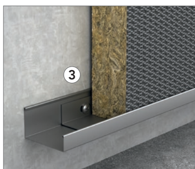
El perfil en J de 40 mm (25/40/13 mm) y la pierna de apoyo se utilizan para soportar la parte inferior de los paneles de pared cuando se montan en varias alturas o fuera del piso. Cuando se utiliza el perfil en J de 1 mm de grosor, no se necesitan piernas de apoyo.
