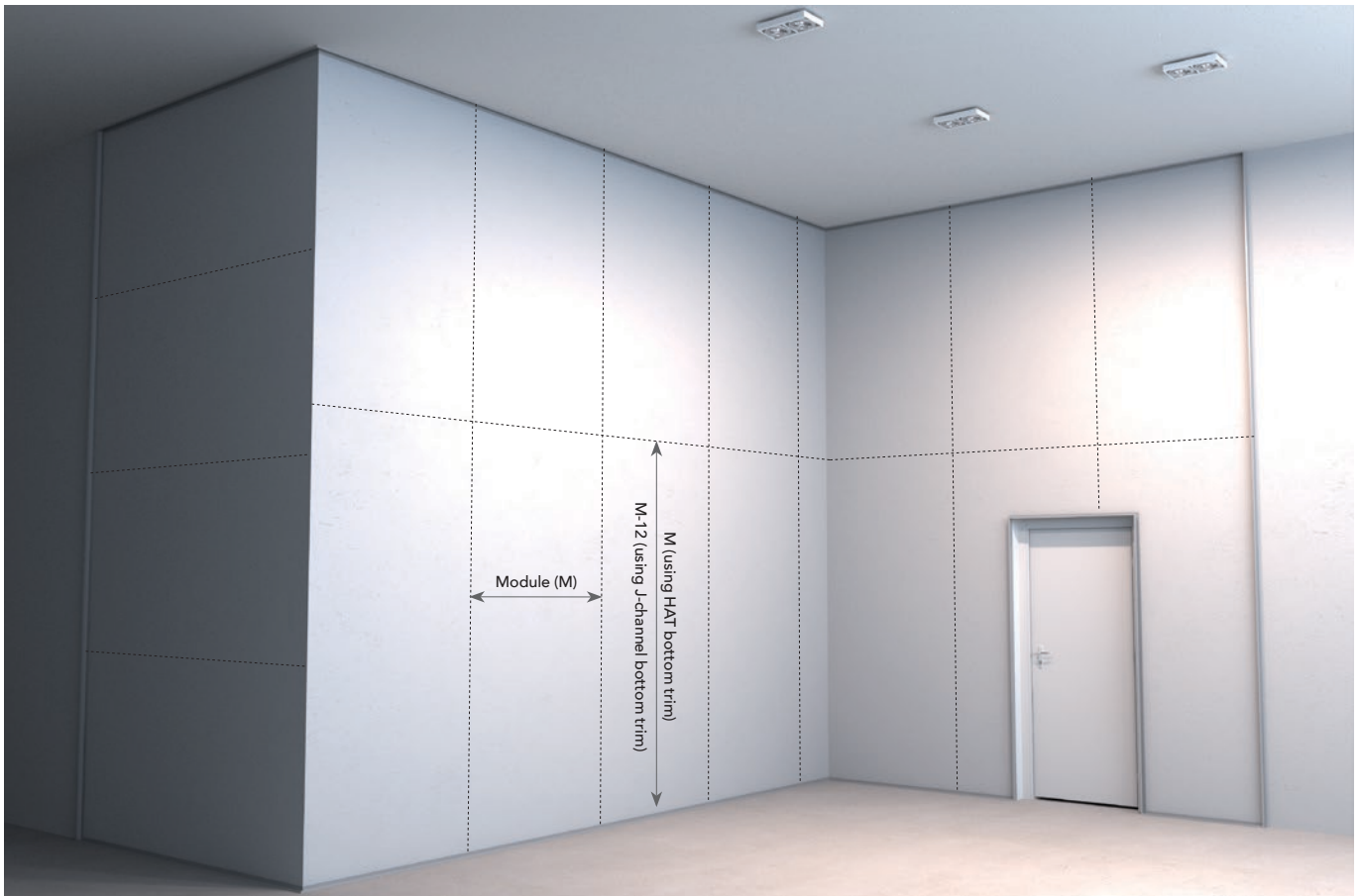
1.1 Marque todos los ejes para acabados perimetrales y perfiles intermedios.
