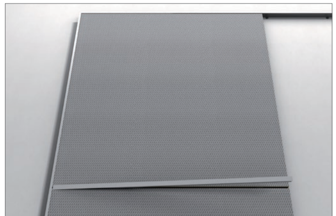
3.6 Skjul de vandrette samlinger mellem pladerne ved at klikke T24-profiler på plads i T-montagebeslag og køre dem derefter forsigtigt ind under J-profilen. Disse vandrette T24-profiler skal tilskæres nøjagtigt til M-12 mm.
