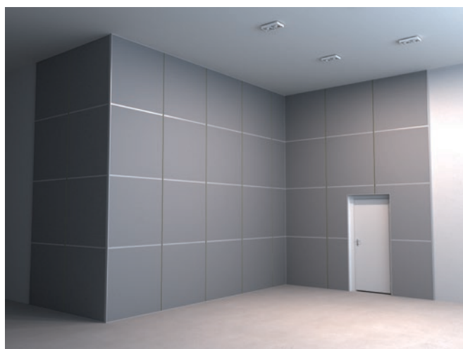
3.11 Monter alle de resterende midterplader som beskrevet på side 9, idet der arbejdes ovenfra og ned. Skjul alle vandrette samlinger med T24-profiler ved at klikke dem på plads i T-montagebeslag under montagen. Når hele væggen er beklædt med Rockfon System VertiQ vægabsorbenter, skal alle de lodrette samlinger skjules med lange T24-profiler, som klikkes på plads i T-montagebeslag (se næste afsnit).
