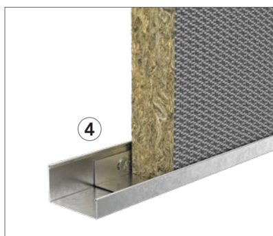
Den 40 mm J-profil (25/40/13 mm) og bærebeklag bruges til at støtte bunden af vægabsorbenterne, hvis de monteres uden gulvstøtte eller som fler-niveau løsning.
