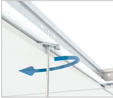
Montering af låseclips med skruetrækker.
