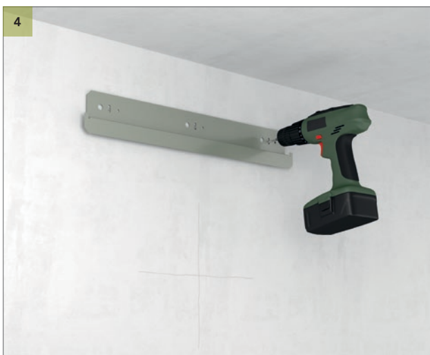
Bor hullerne og monter vægbeslaget - Direct eller Stepped.
