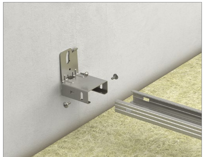
Befestigung des Hold-Down-Systems an aufgehende Wände.
