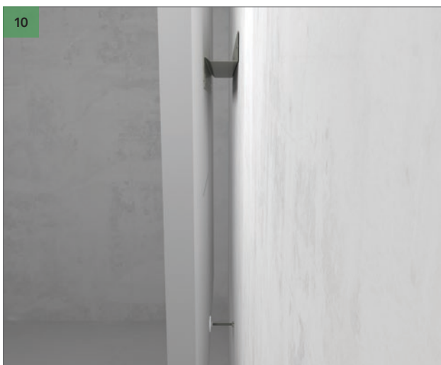
Legen Sie Ihr Rockfon Eclipse-Wandpaneel auf das Wand-Befestigungsprofil auf und stellen Sie den Abstandhalter ein, bis das Eclipse-Wandpaneel gerade ausgerichtet ist.
