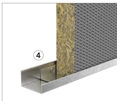
40mm J profil (25/40/13 mm) a držák J profilu k podepření spodní části panelů namontovaných v různých výškách nebo mimo podlahu.
