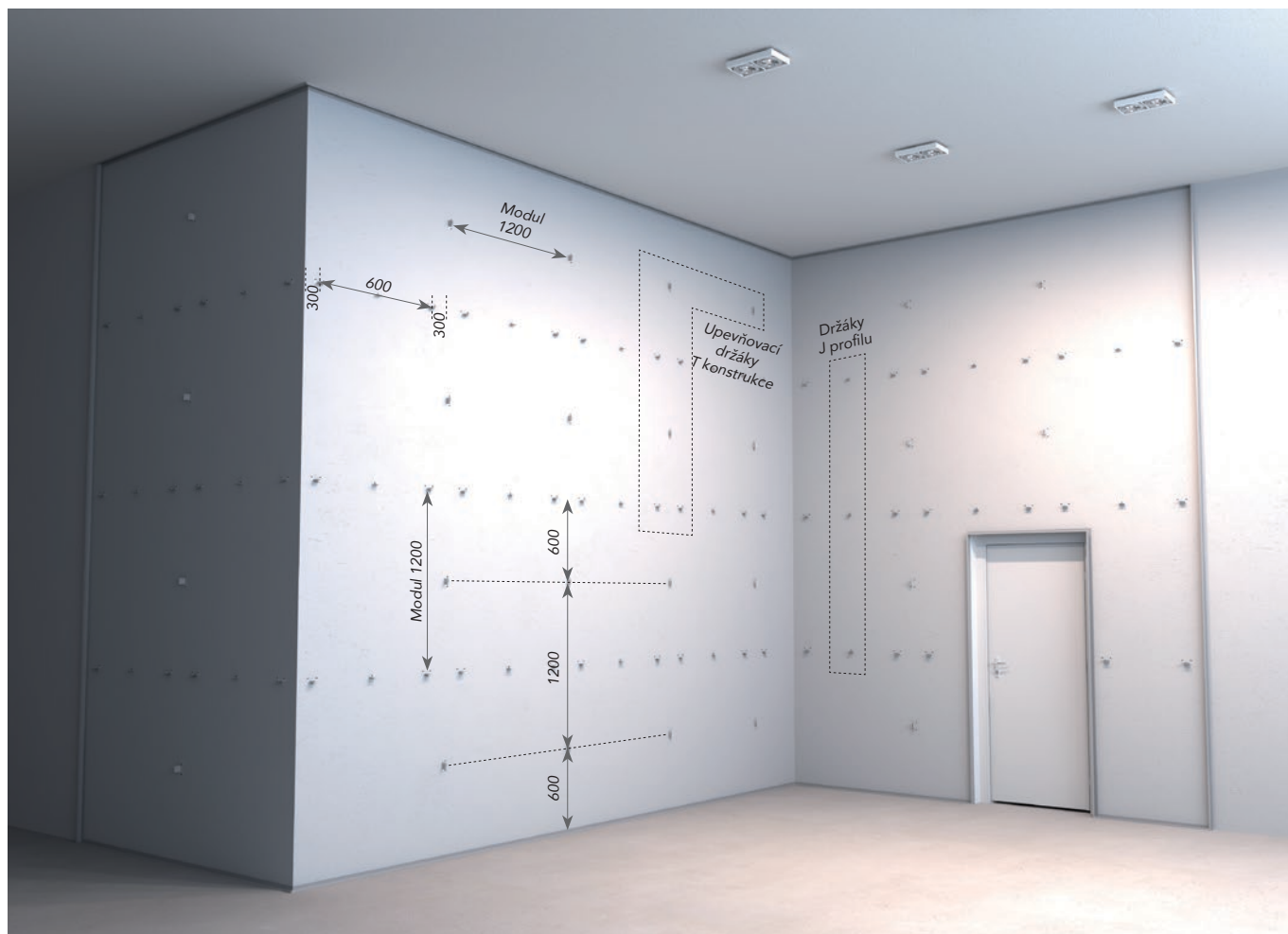
2.1 Umístění všech upevňovacích držáků T konstrukce a držáků J profilu by mělo být vyměřeno a měly by být namontovány před zahájením jakékoli instalace panelů. Tím se výrazně zkrátí doba instalace. Zajistěte, aby všechny držáky byly v jedné linii – profil upevňovacích držáků T konstrukce na ose modulu, spodní strana držáků J profilu 4 mm nad ní.
