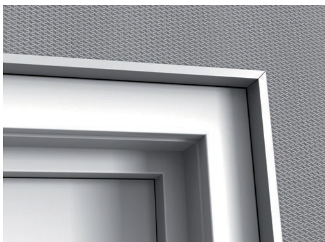
3.9 Zakončení s J profilem kolem dveří nebo okna by mělo být vždy provedeno J profilem připevněným 25 mm širokou hranou ke stěně, upevněným každých 300 mm a 30 mm od všech konců. Abyste minimalizovali množství odpadních panelů, měřte a řežte pečlivě a zároveň zajistěte dostatečný přesah J profilu.
