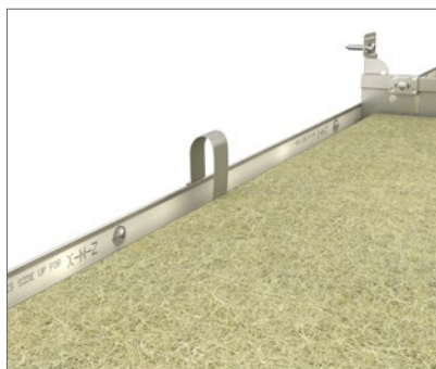
K zajištění perfektního umístění stropních desek Rockfon System T24 X doporučujeme použít pružné stěnové svorky.
