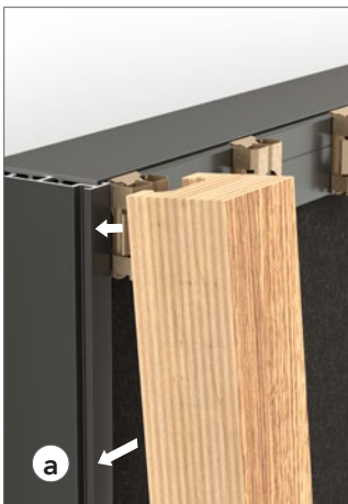
Ausrichten der Lamellen am Querprofil.
