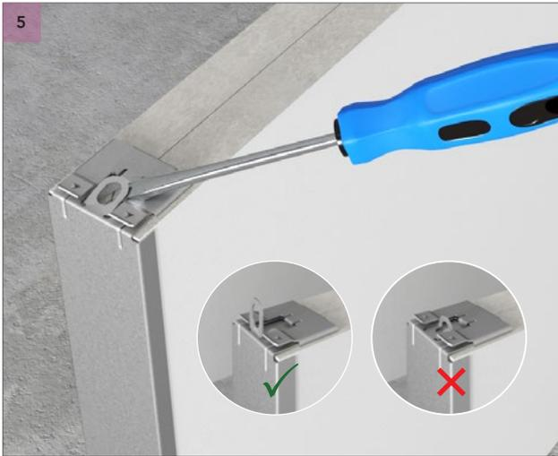
Biegen Sie die Befestigungsschleife auf, so dass diese komplett senkrecht steht.
