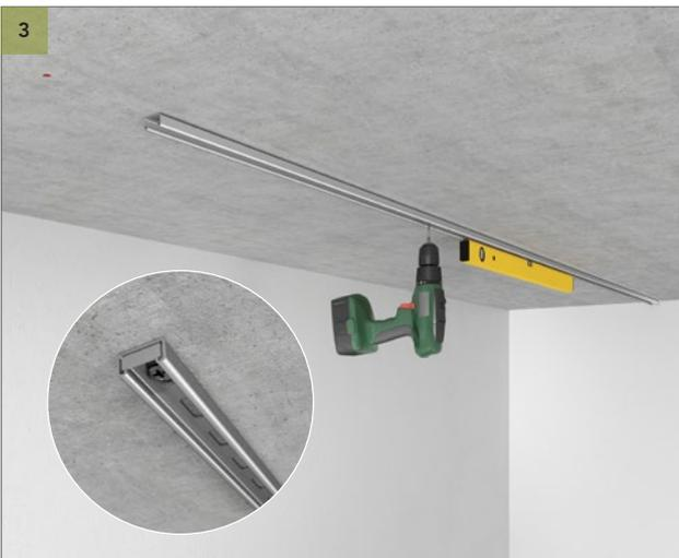
Befestigen Sie die Führungsschiene und achten Sie auf eine exakte Ausrichtung. Bei Unebenheiten im Untergrund sollten an den Befestigungspunkten geeignete Ausgleichsplättchen verwendet werden. Falls erforderlich kann an dem offenen Ende der Schiene der Endanschlag montiert werden.
