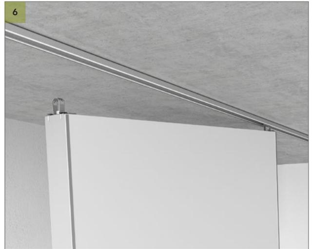
Die an der Baffel montierten Clips werden in die Führungsschiene eingeklickt. Ein hörbares "Klick"-Geräusch signalisiert die korrekte Montage.
