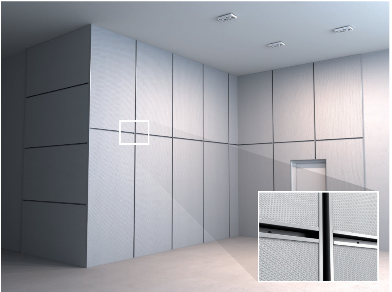
3.1 Alle Rockfon VertiQ-wandpanelen en HAT-profielen geïnstalleerd.
