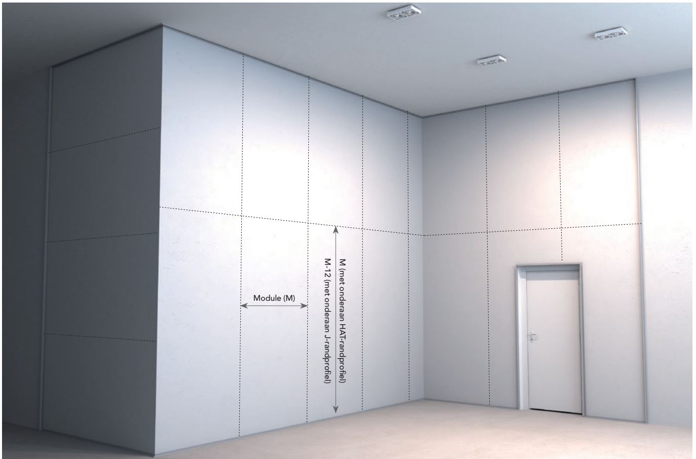
1.1 Markeer alle assen voor de randprofielen en tussenprofielen
