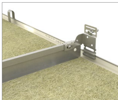
Om de haaktheid van het systeem te waarborgen, wordt geadviseerd om elk hoofdprofiel en elk tweede tussenprofiel aan de wand te bevestigen middels een 90° beugel.
