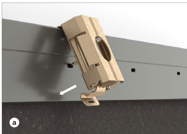
Fixez le reste des clips de montage Rockfon Lamella aux profilés horizontaux en utilisant les trous d'alignement situés sur la face avant de ces derniers.
