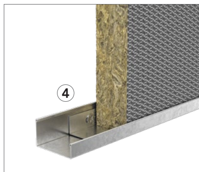
Profil périphérique en J 40 mm (25/40/13 mm) et support pour la base des panneaux montés sur plusieurs hauteurs ou au-dessus du sol.
