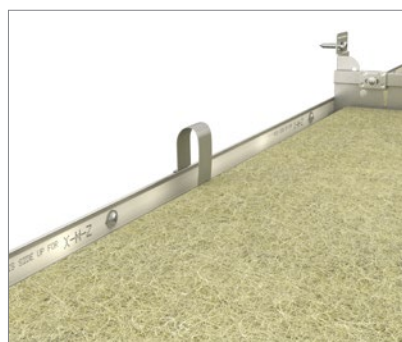
Pour garantir un positionnement parfait des dalles dans le Rockfon System T24 X, nous vous recommandons d'utiliser des ressorts muraux.
