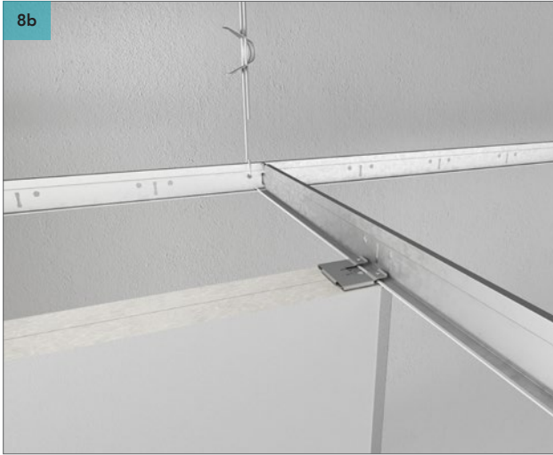
Attacher les baffles Rockfon Industrial à l'ossature Chicago Metallic T24. Vous pouvez utiliser les lumières des profilés T24 comme référence pour aligner les baffles.
