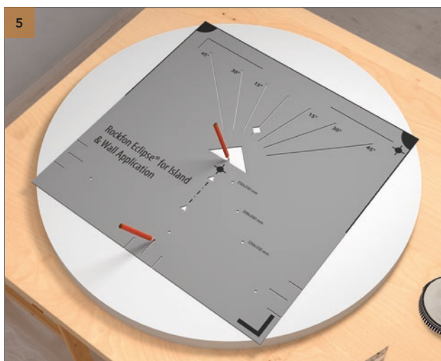
Placez l'outil de marquage au dos de le panneau mural et marquez au crayon la base du triangle et la position de l'écarteur. Voir 5 - Résultat.
