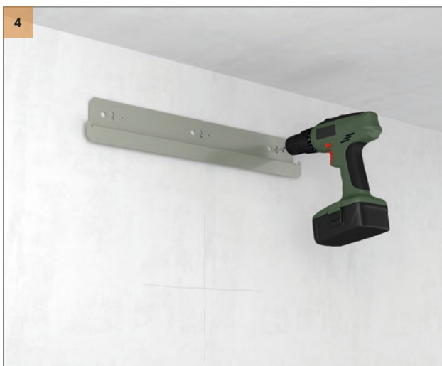
Percez les trous et installez le profilé de fixation murale.
