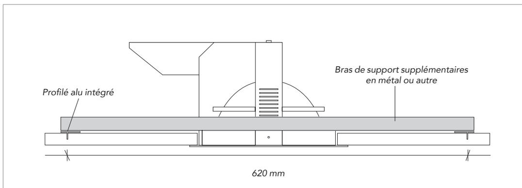
Cette solution convient aux luminaires (ou autres techniques) de 5 kg. Fixez le spot au moyen des deux bras de support supplémentaires qui reposent sur les profilés alu intégrés.
